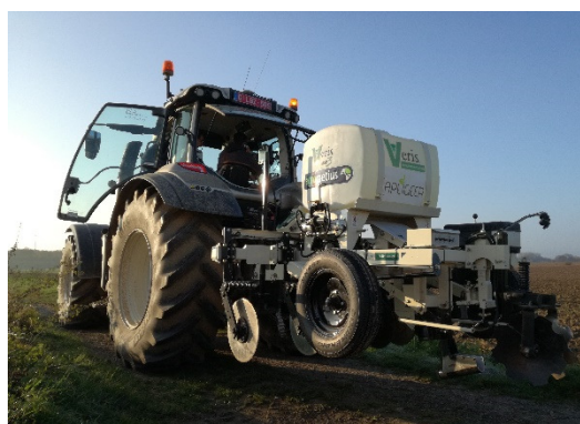
Tracteur équipé d'un « Veris », pour la réalisation de mesures géoréférencées en essais de cultures maraîchères
